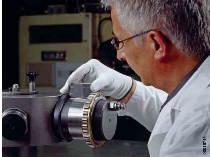
图 4 测量轴承内圈到轴肩的距离
