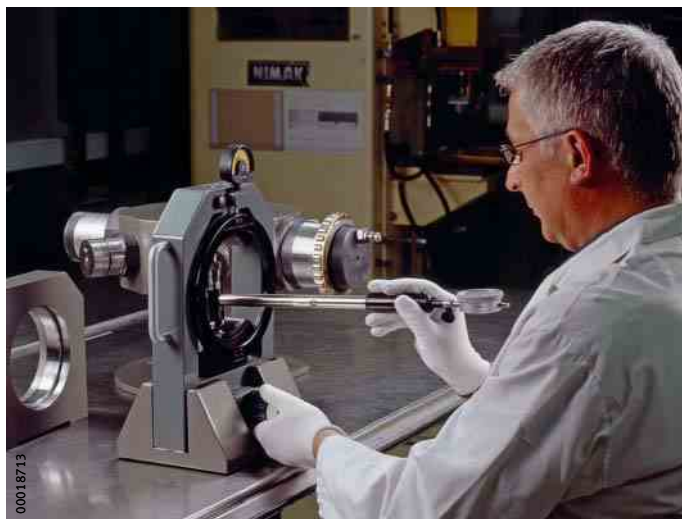
图 2 将测得的直径传递给包络圆测量仪
