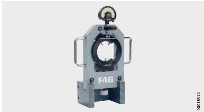
图 6 用于可分离外圈的 圆柱滚子轴承的包络圆测量仪
