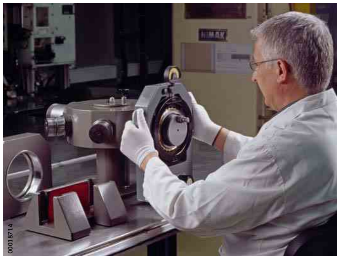
图 3 放置包络圆测量仪
